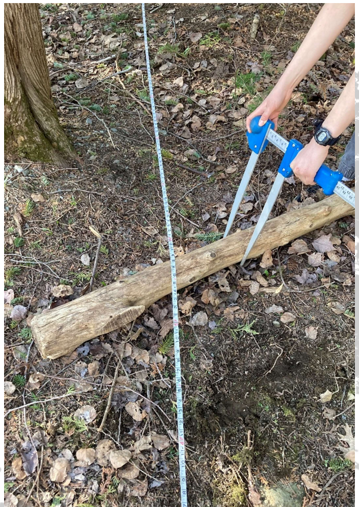
Photo (ci-dessus) : Débris médium (diamètre sur le transect : moins de 30,1 cm), forme standard (S), classe de décomposition 2, le diamètre mesuré est celui sur le transect (12,1 cm), la longueur est mesurée du gros bout (gauche) jusqu'au caliper, où le diamètre est de 10,0 cm (soit le minimum pour l'inventaire).
